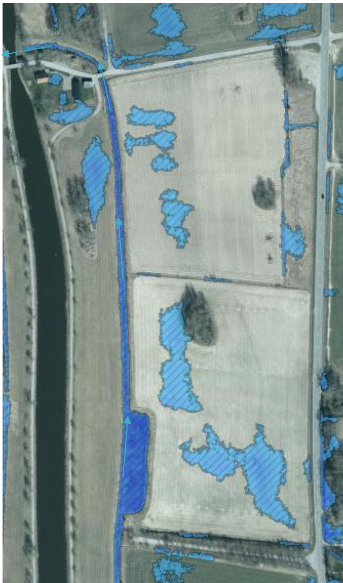
Figur 5. Instängda områden (skrafferade ytor i ljusblått) i och intill planområdet. Diket som leder bort vatten från planområdet har en mörkare nyans och flödesriktningsspilar.
