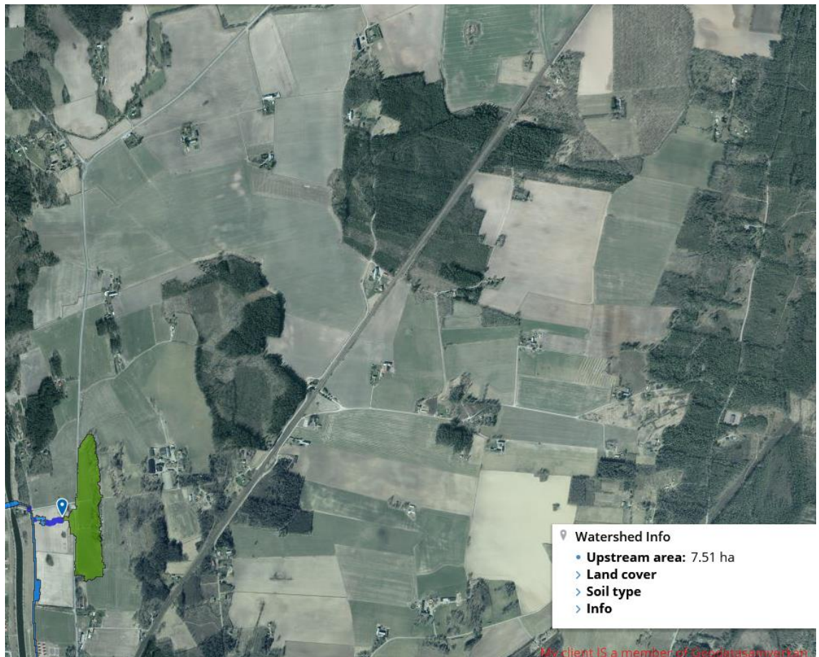
Figur 3. Avrinningsområde till en punkt alldeles nedströms lågpunkten i väg 200 vid normala avrinningsförhållanden.
