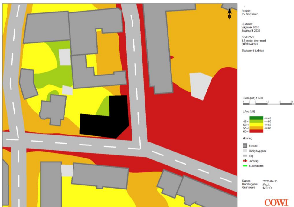
Figur 4. Ekvivalent ljudnivå vid uteplats. Grön färg indikerar att riktvärdet innehålls. Kv Snickaren är markerat med svart
