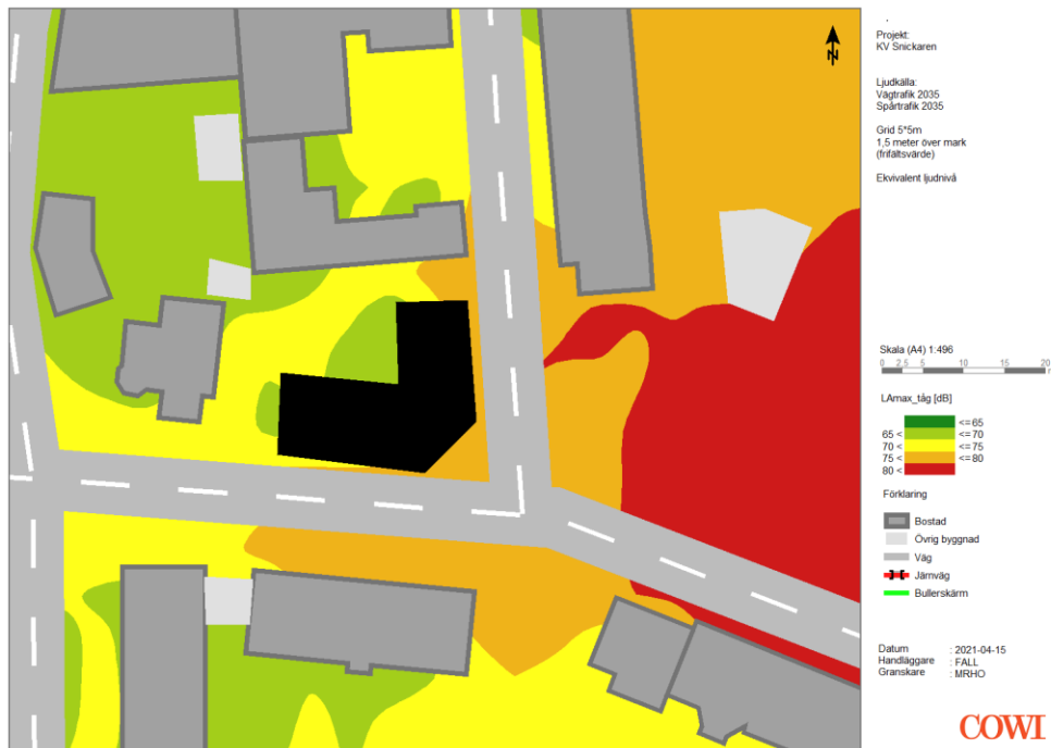
Figur 6. Maximal ljudnivå från tåg. Grön färg indikerar att riktvärdet innehålls. Kv Snickaren är markerat med svart
