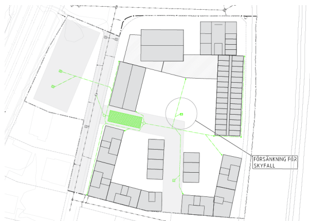
Figur 26: Dagvattenhantering med sprängstensmagasin.
